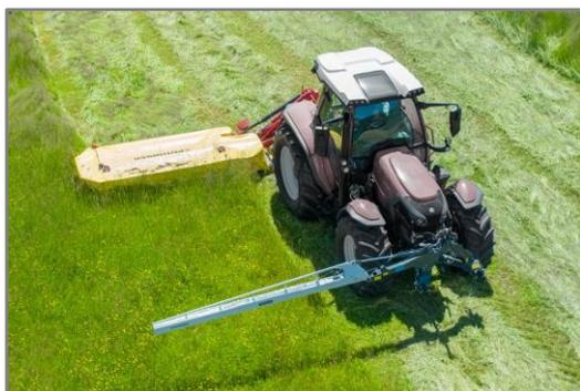
*Dispositif Sensosafe fixé à l'avant du tracteur (Pöttinger)*
